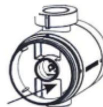
4. Saque el nuevo cartucho de filtro, asegúrese de que tenga el anillo de sellado y la almohadilla del anillo de sellado, luego coloque el cartucho en la carcasa del filtro del grifo.
