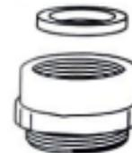
3. Gire el conector para golpear y apriete con una moneda. Bloquee la salida de agua con los dedos, abra el grifo, compruebe si hay fugas de agua o no en la conexión.
