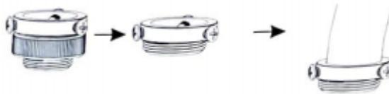
3. Apriete la mitad inferior del conector de conversión. Bloquear la salida de agua con los dedos, abrir el grifo, comprobar si hay fugas de agua o no en la conexión
