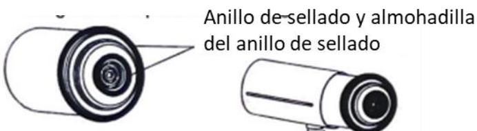
5. Carcasa del filtro vertical hacia arriba, gire la carcasa hacia el cuerpo principal en sentido anti horario.
